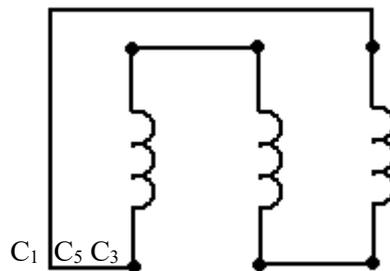
Вопрос 16.Соотношение между фазными и линейными токами  $I_L = \sqrt{3}I_\Phi$  справедливо для симметричных потребителей, соединенных по схеме:
